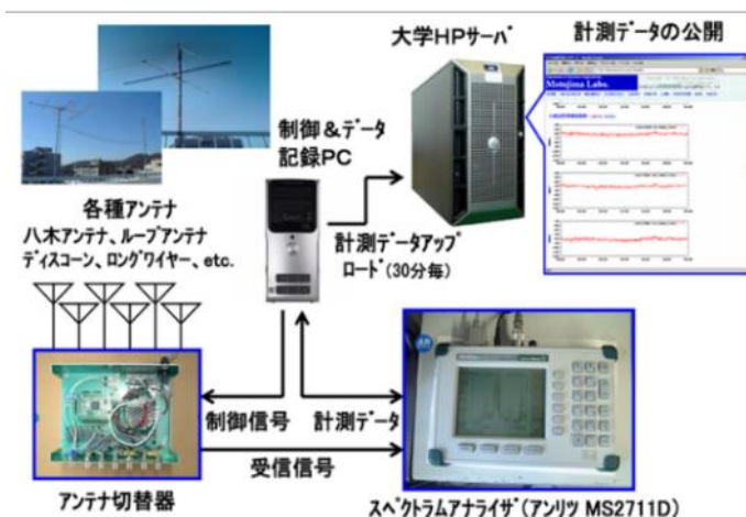
図 1 広帯域電波伝搬観測システム構成
