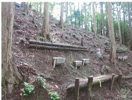
災害に強い森林の育成技術の確立を目的とした、間伐木を利用した筋工による土砂流亡抑制効果などの調査
